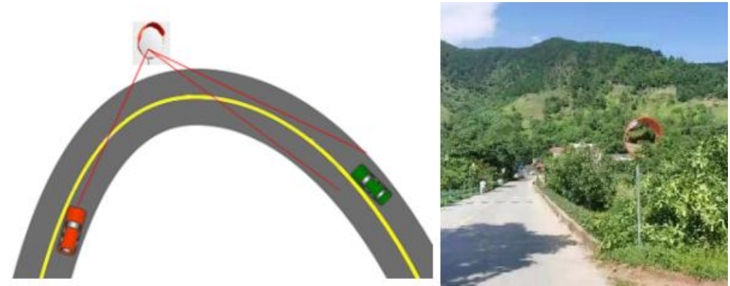
凸面镜安装示意
